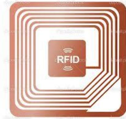
RFID o Radio Frequency IDentification (Identificazione a radio frequenza) è un sistema ad onde radio che permette l'identificazione automatica di cose o persone. Il sistema si fonda su un lettore e un tag (attivo o passivo), il quale quando entra nel raggio d'azione del lettore, invia al sistema le informazioni richiestegli.
